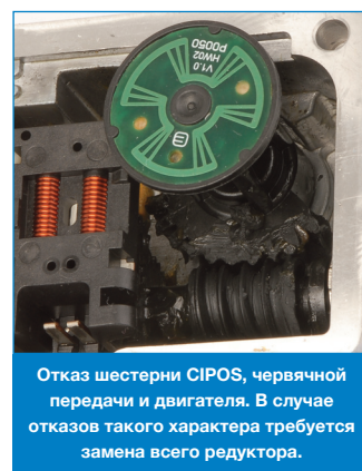
Отказ червячной передачи по причине ограничения механизма регулируемого соплового аппарата турбины
