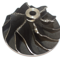
Точечная коррозия на лопатках компрессора
