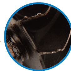
Повреждение направляющих лопаток компрессора или колеса турбины
