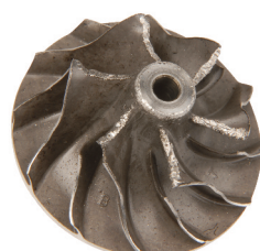
Повреждение направляющих лопаток компрессора или колеса турбины
